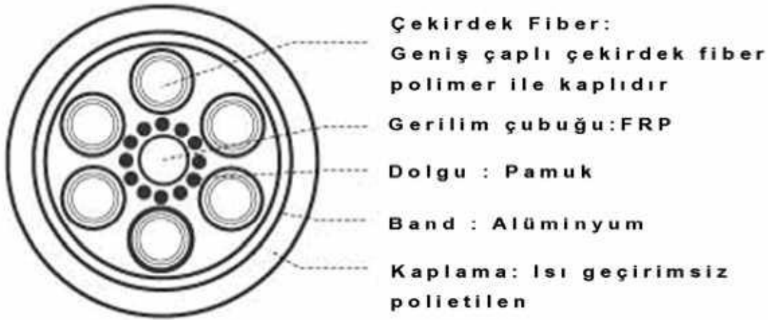
Şekil 15. Fiber Optikler Metodunda Kullanılan Fiber Kablonun İç Kesitinin Gösterilmesi
