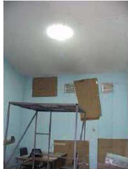
Şekil 18. Ege Üniversitesi Test Odasında Fiber Optik Kablolar İle Gün Işığının Etkin Kullanılması Gösteren Uygulama Örneği
